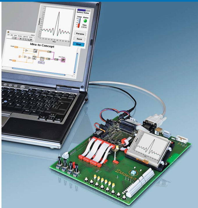
Bild 2: Das ZBrain-Entwicklungssystem ist eine grafisch programmierbare Entwicklungs- und Testumgebung mit skalierbarem Prozess I/O.
