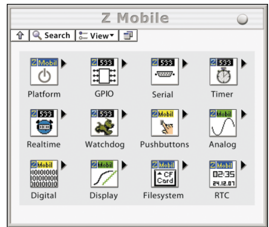
Bild 3: Standardisierte Funktionsblöcke/VIs ermöglichen sofortige Grafische Embedded System Programmierung.
